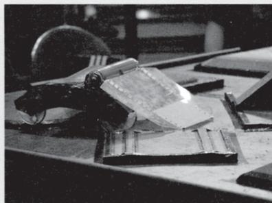
写真7 前面を広くカバーするシールドで、対戦相手からの攻撃を防ぐとともに、大きく上下させることで対戦相手をすくい上げる「シールドアーム」。攻防の両面に長ける、操縦者の腕が決め手の汎用アーム。写真は、攻撃的なシールドアーム機として知られる「Leopard VVV」。
