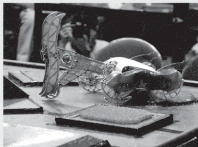
写真9 大型機によく見られる「回転アーム」。前方に突き出したブレードを高速回転させて、それに触れた対戦相手を弾き飛ばす一撃必殺のアームだ。ブレードを支える腕は上下動にも柔軟に対応できるので、障害物も苦にしない。写真は東京電機大学自動制御研究部の「Allegro」。
