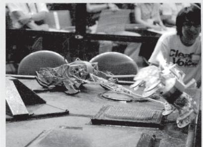
写真8 前方に長く伸ばした細長い棒に対戦相手の足下にすべり込ませて、そのまますくい上げる「ロッド(棒)アーム」(左)。下段に構えるので、中央丘を挟んだ揺さぶりは苦手。写真は決勝トーナメント2回戦の「天空に舞う混沌女神-輝-」(左) vs 「稲」(右)。
