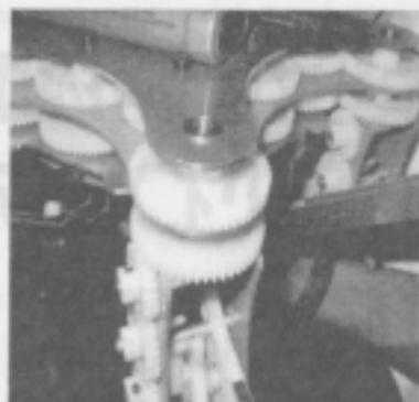
上の段のギアで足を動かし、下の段のギアで足の向きを変えていた「鱷」。それぞれの段でギアを15個ずつ、全体では数え切れないくらいギアを使っているという。
