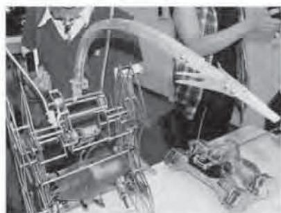
グニャリと曲がる「鉄心琴」のロッドアーム。片側のみのポリカーボネートで固定しており、一方にのみ曲がる仕組み。
