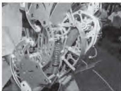
初めて導入したサスペンション。ロングアームがブレなくなったことで、攻撃の精度も向上する。
