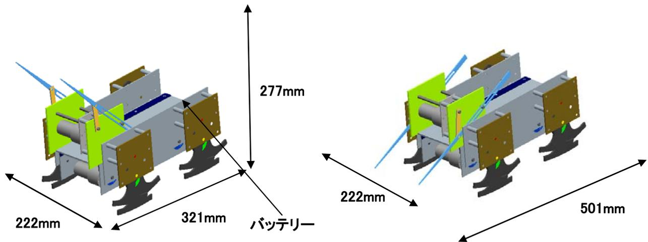
ロボットの大きさは縦321mm、横222mm、高さ277mmです。計測時はアームを持ち上げることでスタート台に収まるサイズになります。バッテリーは大会規定バッテリーを3本使用します。
