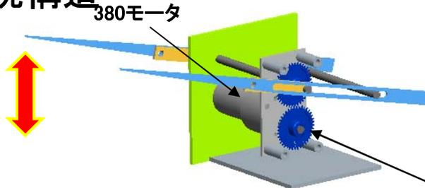
・アーム構造には、スライダリンク機構を用いています。
