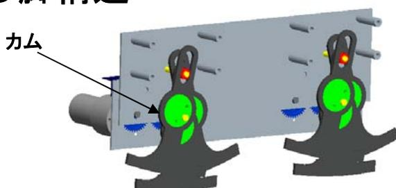
・脚の機構は120度位相のクランクシャフトを利用したスライダークランク機構です。
