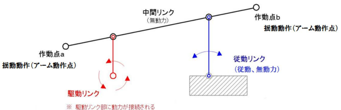
リンク機構 参考例:四節リンク機構による動作軌跡
