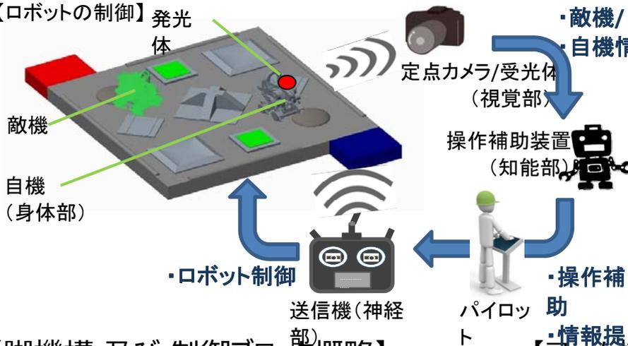
本機は、パイロットと送信機のみならず、自機/敵機情報を取得する定点カメラ(受光体)、取得した情報を元にパイロットへの情報提示や補助を行う操作補助装置と連携して操作することが可能である。
