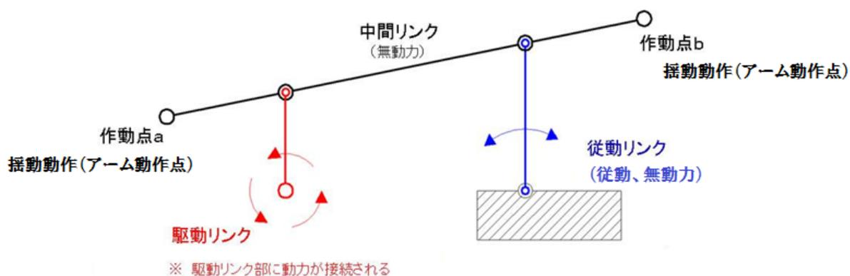
リンク機構 参考例:四節リンク機構による動作軌跡
