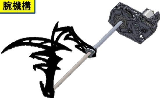
スライダクランク機構を利用した横回転アーム機構を搭載します。リンクの中間リンクの部分にあたる爪部分で相手を攻撃します。但し、刃の形状やシャフトの長さは規定範囲内で試合毎に変えることが出来ます。刃の先端は任意のタイミングで高さ200mmを超えることが可能です。動力であるモータの回転部分から、アーム作動面までの間にスライダクランク機構を介しており、動力部のリンクが一回転する間に、爪の先端は充分に間隔の空いた2点以上の円弧中心を持つ連続した曲線を往復します。攻撃部分の旋回基部にも同様の機構を用いています。(腕機構部の詳細な動作説明については添付シート参照)
