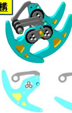
ヘッケンリンクを応用した四節リンク機構を搭載しています。左図のような3枚1組で1ユニットを構成する脚を左右に2ユニットずつ搭載し、合計4ユニットの脚を搭載します。下図のように、動力部のリンクが1回転する間に一枚の脚が120度の揺動運動を行います。また、動力伝達にはギアを使用しており、各ユニットに動力伝達をすることが出来ます。
