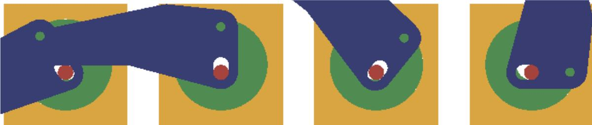
図3 アームのリンク機構動作 ※動作が分かりやすいようにデザインとリンクの比率を変更
