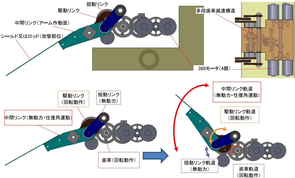
中間リンク(アーム作動面)が駆動リンクから動力を得て運動するとき、上図のように十分に離れた2点の円弧中心を持つ連続した曲線を往復する動作をする。
