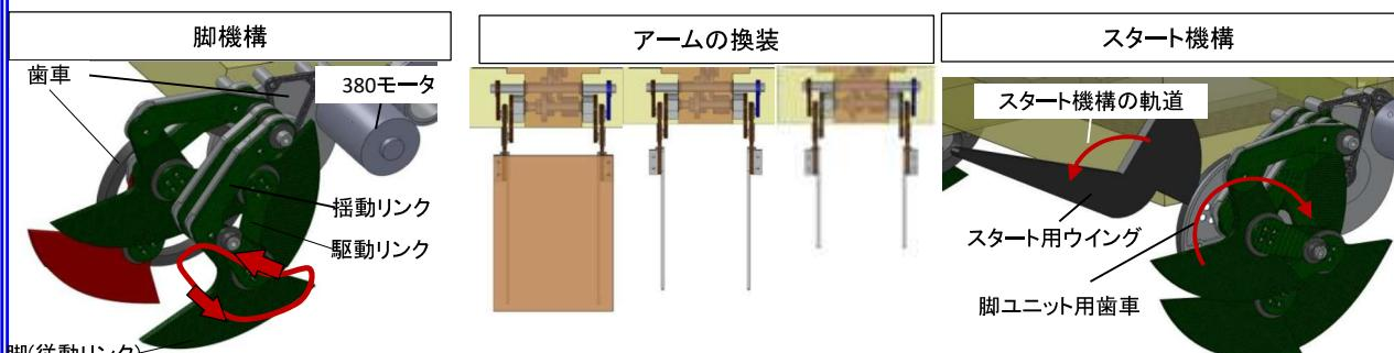
脚は図のように四節リンク(ヘッケンリンク)を応用したものとする。この脚の軌跡を赤矢印で示した。接地面はクランクの回転中心よりも地面側を通るものとする。4つの脚を90度位相にしており、380モータから歯車で脚に力を伝達できるようにしたものを1つのユニットとしている。脚ユニットは本体の前後左右に1つずつ、計4つで構成する。詳細は添付シート参照。
