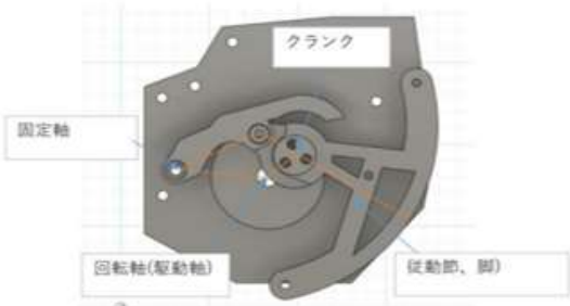
図2 脚部(ヘッケンリンク)の詳細
