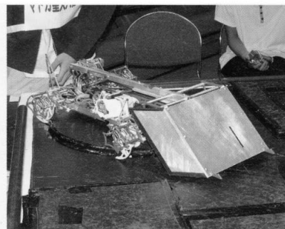
“ハイブリッド型”の一例。シールドのスリットからロッドを出せる。
