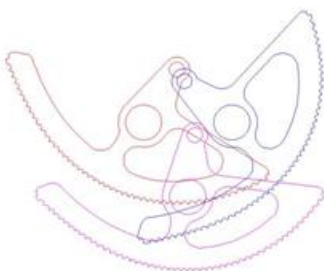
クランク機構とヘッケンリンク機構を組み合わせた脚
